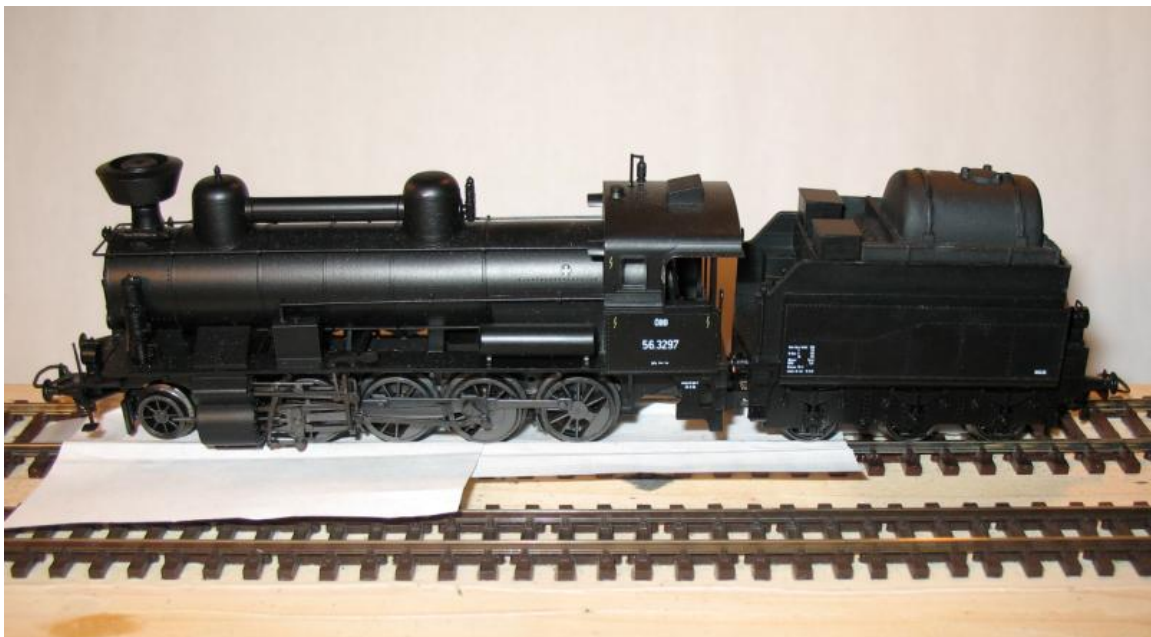
Abb.6: Die Klein Modellbahnen Reihe56 überfährt ein stromloses Stück Gleis von etwa 20 cm Länge.
